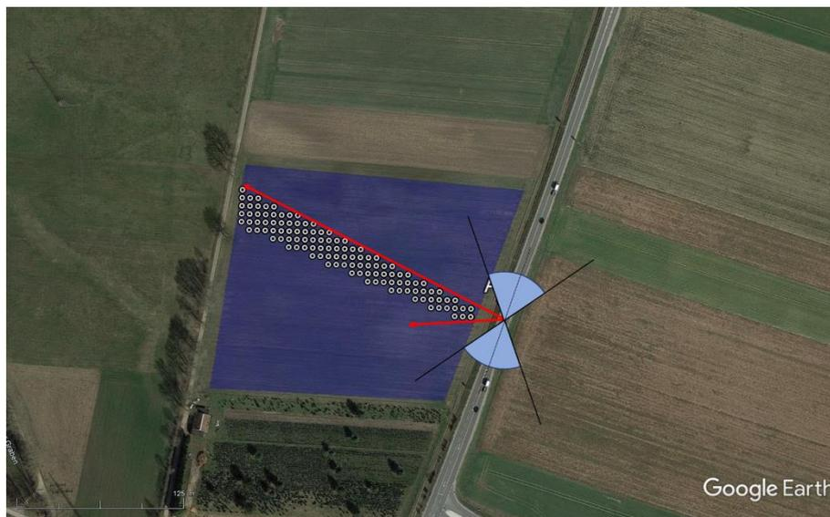
Abbildung 23: Vergleich Sichtfeld Fahrzeugführer für Punkt A3 mit Grenzvektoren in Richtung Module (Modulneigung  $15^\circ$ )
