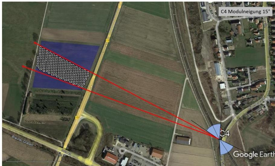
Abbildung 25: Vergleich Sichtfeld Zugführer für Punkt C4 mit Grenzvektoren in Richtung Module (Modulneigung 15°)
