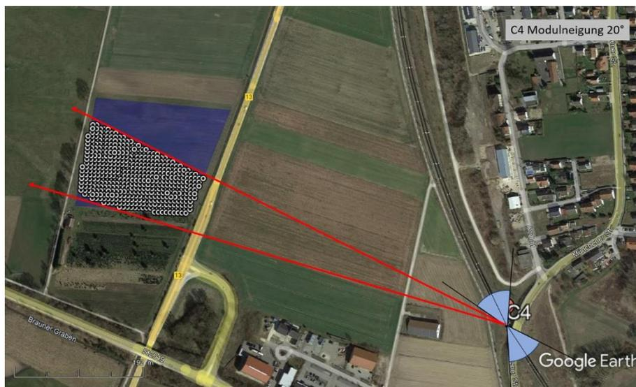
Abbildung 26: Vergleich Sichtfeld Zugführer für Punkt C4 mit Grenzvektoren in Richtung Module (Modulneigung 20°)
